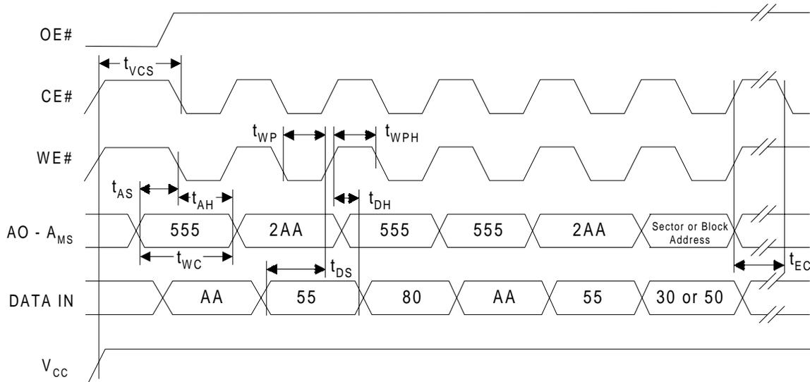
**TOGGLE BIT AC WAVEFORMS**
